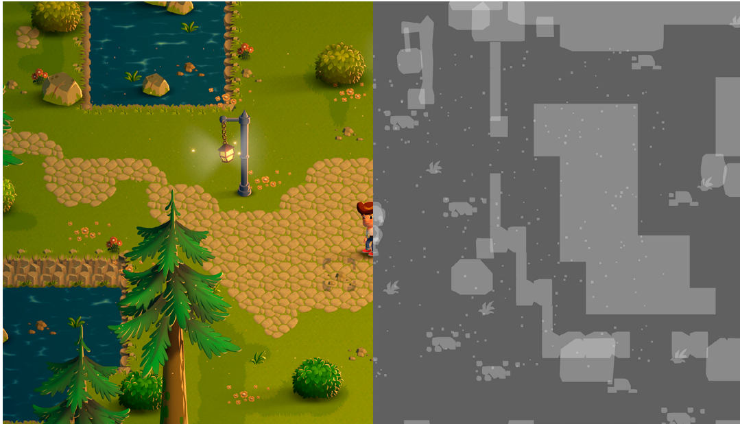
Happy Harvest の画像 - 右側では、レンダリングデバッガーでオーバードローモードが有効になっており、明るい領域は重なり合うピクセルを示し、暗い領域は重なりが少ない場所を示しています。
