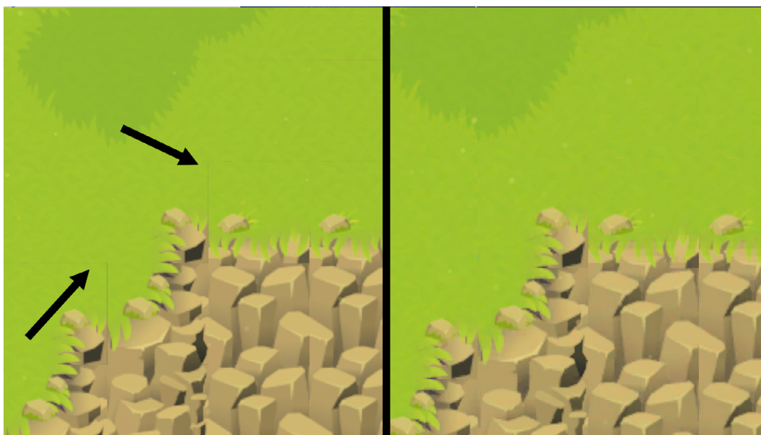
左の画像では、タイルの端にじみが見られますが、スプライトアトラスの設定を調整することで修正されました。
