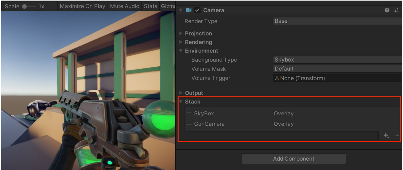
URP の Camera Stacking。銃と背景が異なるカメラ設定でレンダリングされる。
