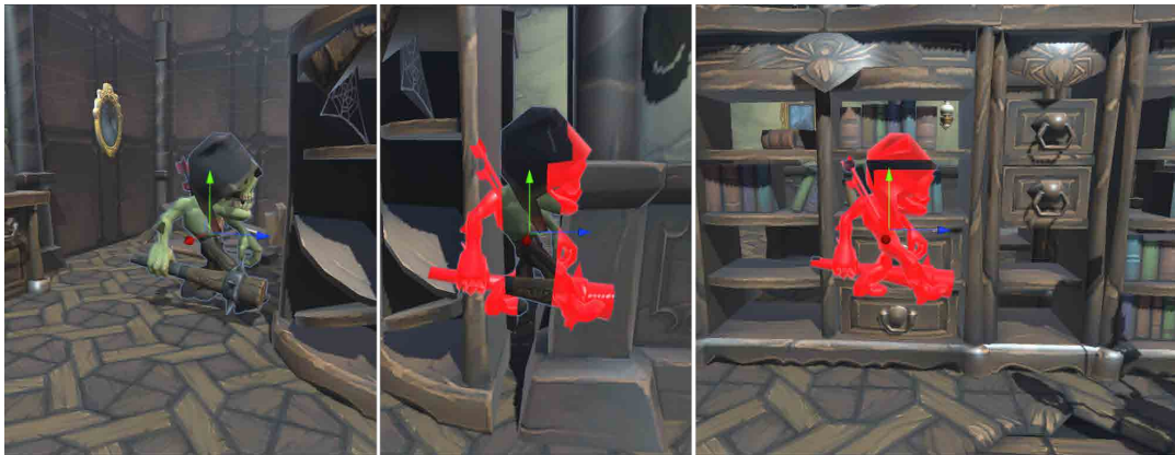
環境モデルによってキャラクターが隠れている時にシルエットを表示する
