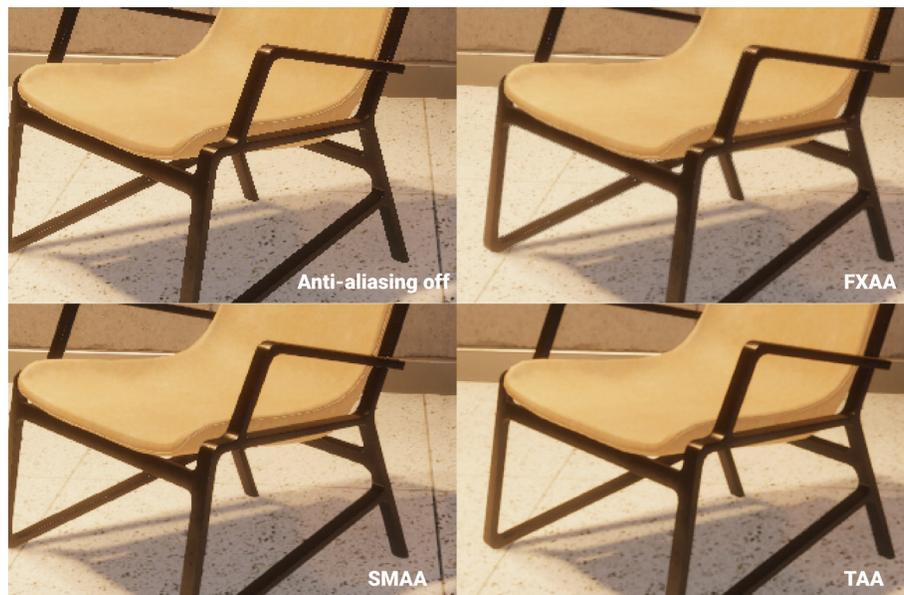
ポストプロセスのアンチエイリアシング：FXAA、SMAA、TAA の各設定の結果を比較。
